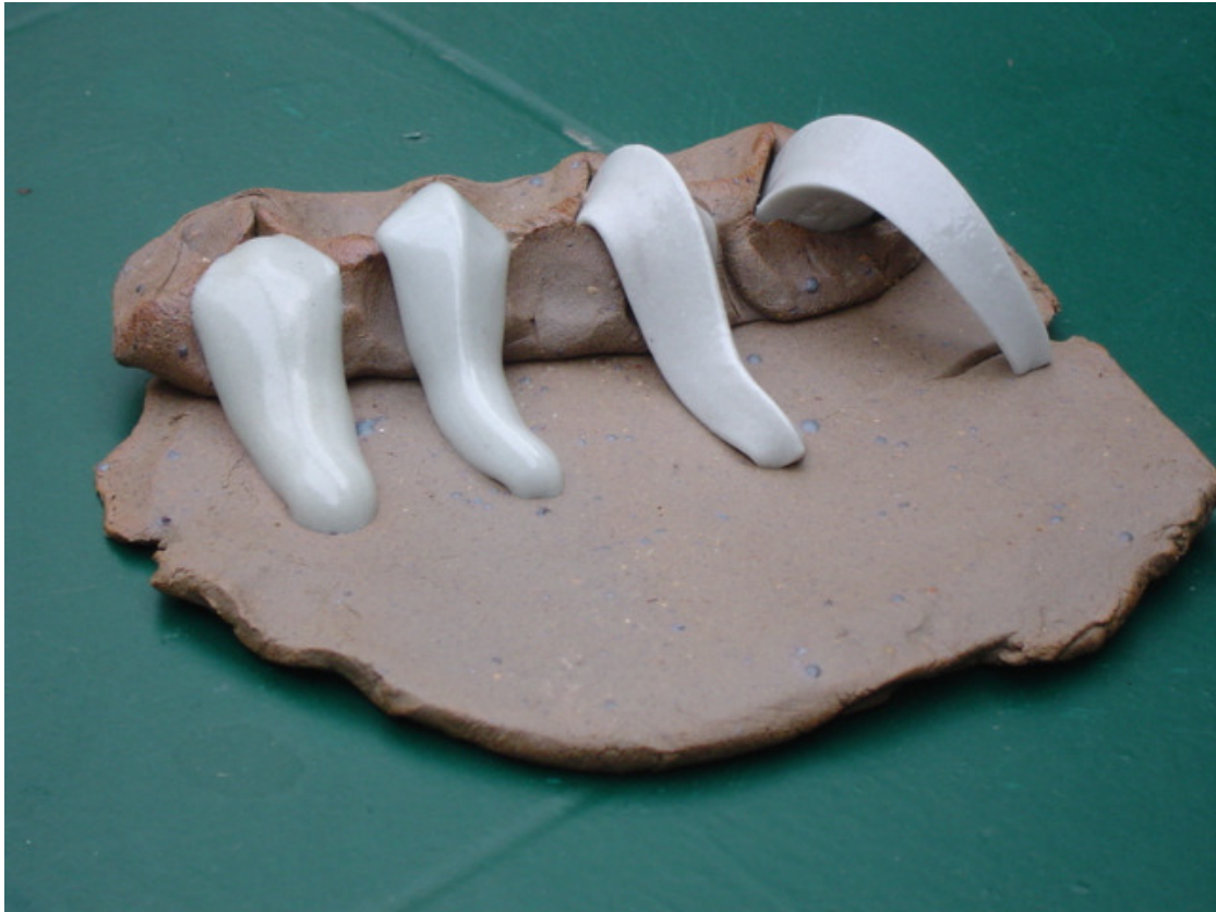
FIGURE 3 – cônes de Seger n° 6 à 9 après cuisson.
