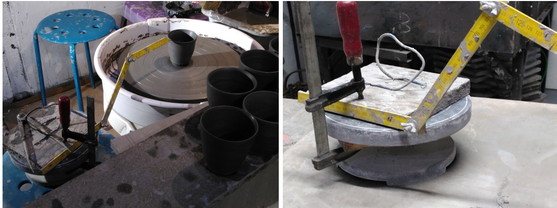
FIGURE 4 – Tour non modifié et trusquin.
